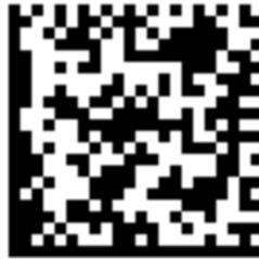
La capacità di un codice a barre DataMatrix è di circa due migliaia di caratteri e il sistema di correzione degli errori non prevede la scelta di livelli regolabili.
