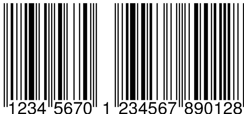
Il codice di controllo di EAN-8 e di EAN-13 si calcola nello stesso modo di UPC-A. Per esempio, nel caso di 1234567 (EAN-8) si ottiene il codice di controllo zero, mentre nel caso di 123456789012 (EAN-13) si ottiene otto.
