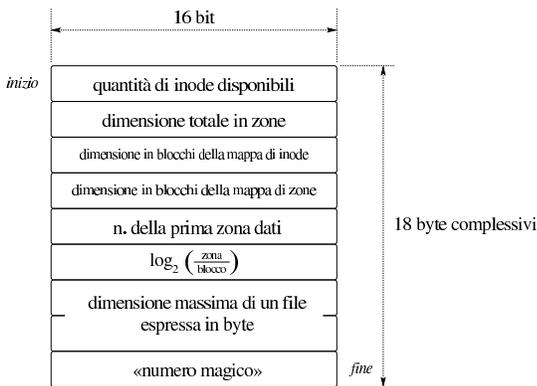
Il secondo campo del super blocco, come si vede dalla figura, rappresenta la dimensione dell'unità di memorizzazione (o della partizione considerata), espressa in zone. Per esempio, se si utilizzano zone uguali ai blocchi, un dischetto da 1440 Kibyte è composto esattamente da 1440 zone.
