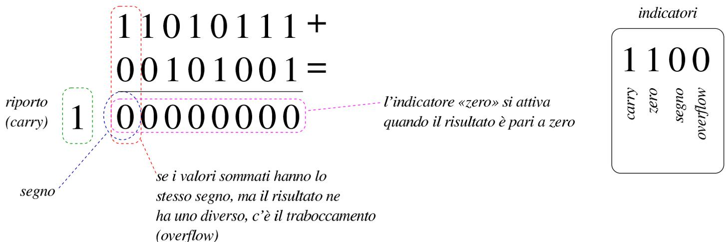
Figura 63.50. Somma di interi: se i numeri sono da intendersi senza segno, il risultato è completo in quanto non si genera un riporto; se i numeri sono da intendersi con segno, in tal caso hanno segni diversi tra di loro e questo impedisce che si crei un traboccamento, inoltre il risultato è negativo e questo attiva l'indicatore di segno.
