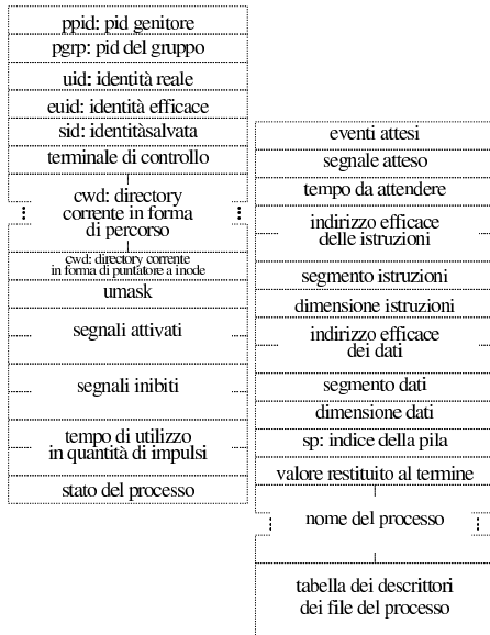
Listato u149.20. Struttura del tipo 'proc_t', corrispondente agli elementi dell'array proc_table[] .
