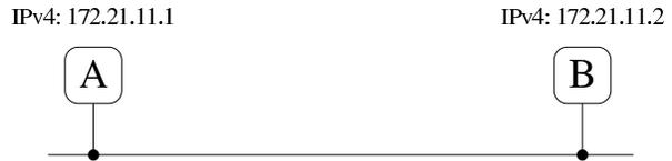
Figura 83.140. Esempio di pacchetto «ping», inviato dall'indirizzo 172.21.11.1 a 172.21.11.2. Il pacchetto IPv4 non è frammentato (**MF** = 0) e non è nemmeno frammentabile (**DF** = 1).
