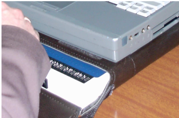
Figura 14.137. Dettaglio delle celle di un terminale braille.
