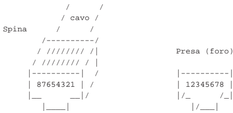
Figura 9.157. Cavo Ethernet 10baseT diretto. Le coppie 1-2 e 3-6 sono ritorte.
