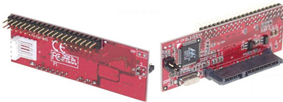
Figura 9.45. Adattatore da bus SATA a disco PATA. Questo adattatore si applica al disco PATA.
