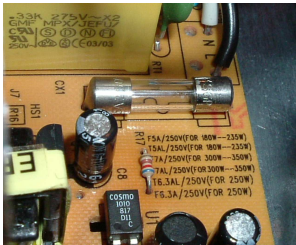
Figura 9.6. Fusibile. In questo caso, il fusibile è saldato e non può essere sostituito facilmente.
