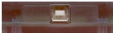
Figura 9.62. Connettori USB: quello in alto va collegato all'unità di controllo (tipo «A»), oppure al concentratore, mentre quello in basso va collegato all'unità periferica (tipo «B»).
