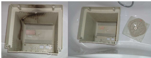
Figura 9.129. Lavaggio del coperchio posteriore di un monitor, con l'aiuto di una doccia. Sulla sinistra si vede la sporcizia maggiore accumulata in corrispondenza del cavo di alta tensione.
