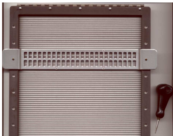
Figura 14.128. Tavoletta di scrittura braille normale.
