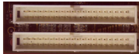
Figura 9.27. Connettori per due canali PATA su una scheda madre. Il terminale numero uno si trova sul lato destro. Si osservi l'assenza di un piedino nella parte centrale del connettore.
