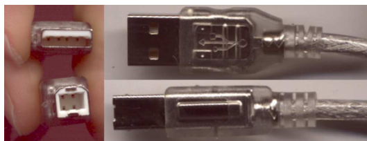
Figura 9.62. Connettori USB: quello in alto va collegato all'unità di controllo (tipo «A»), oppure al concentratore, mentre quello in basso va collegato all'unità periferica (tipo «B»).
