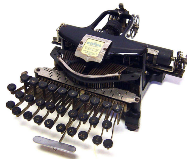
Figura 14.5. Macchina da scrivere Postal 5, del 1904. Questa foto proviene da: Richard Polt, The classic typewriter page , http://site.xavier.edu/polt/typewriters/ .
