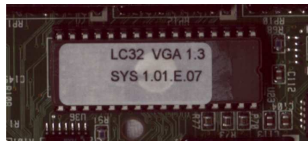
Figura 9.73. Memoria «flash» degli anni 1990, riprogrammabile senza bisogno di estrarre l'integrato dalla scheda madre.
