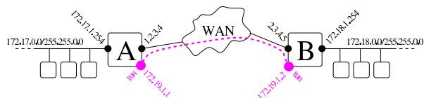
Figura 44.111. Due reti private connesse attraverso un tunnel, in modo da poter formare una sola rete locale estesa.
