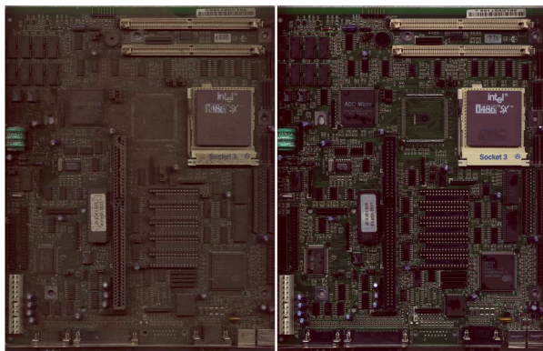
Figura 9.126. Una scheda madre, prima e dopo il lavaggio; quella sulla destra è ancora umida.
