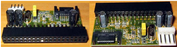
Figura 9.44. Adattatore da bus PATA a disco SATA. A differenza della figura precedente, questo si applica al disco fisso SATA.
